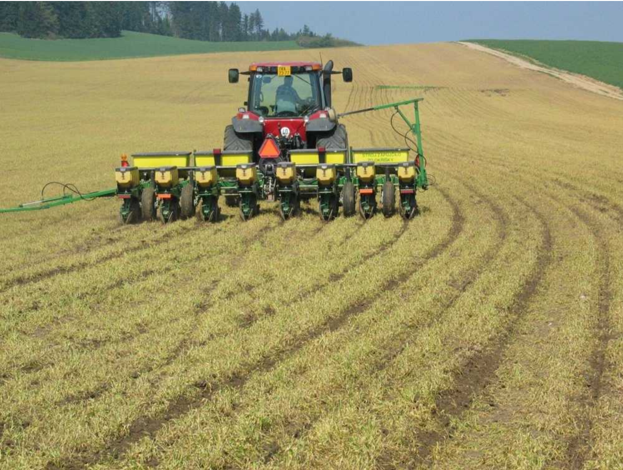
Kukuřice setá bezorebným secím strojem do mulče žita setého (foto ZEA Sedmihorky)
